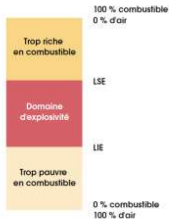
Figure 21 : Domaine d'explosivité – Limites inférieure et supérieure d'explosivité
